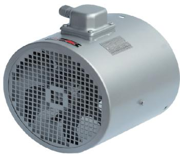
Zespoły obcego chłodzenia typu CHS to konstrukcja składająca się z blaszanego wentylatora osiowego, umieszczonego w wydłużonej obudowie rurowej. Takie wykonanie pozwala na instalację układu chłodzenia na silnikach wyposażonych np. w hamulec lub enkoder. Zaciski przyłączeniowe znajdują się w szczelnej skrzynce zaciskowej, standardowo wyposażonej w dławnicę kablową.
